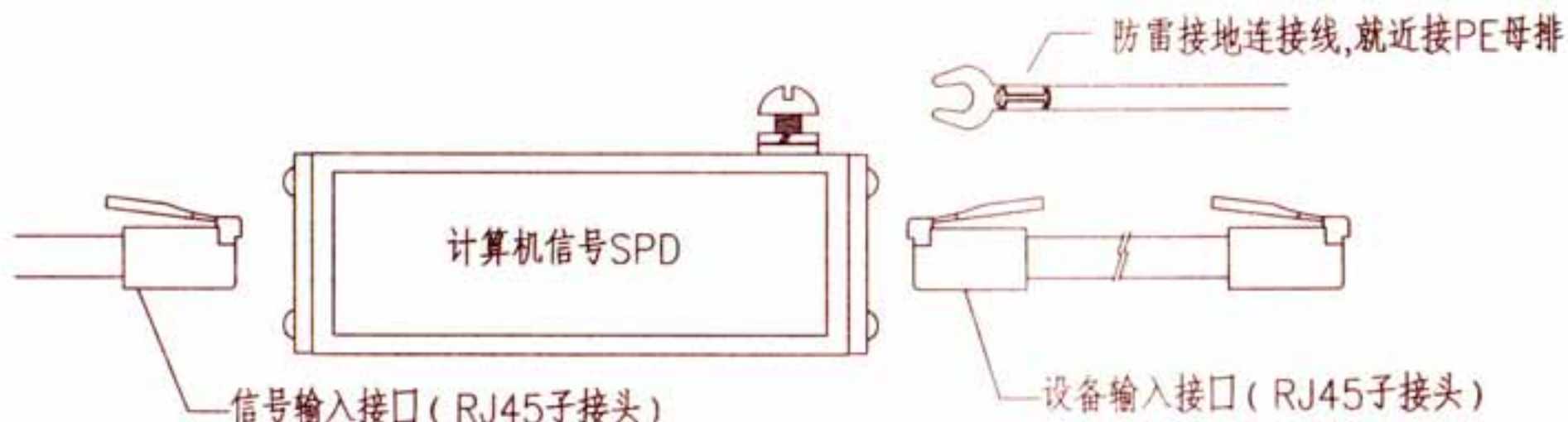
信号RJ45接口SPD安装示意图
